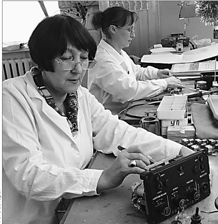
Электромонтажница Римма Мукминова за сборкой вертолетного комплекса автопилотирования.
